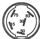
Ключ зажигания DELPHI / MERIT Арт. 327432 Pin30: Аккумулятор Pin15: Зажигание Pin50: Запуск
