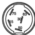
Ключ зажигания DELPHI / MERIT Арт. 327432 Pin30: Аккумулятор Pin15: Зажигание Pin50: Запуск
